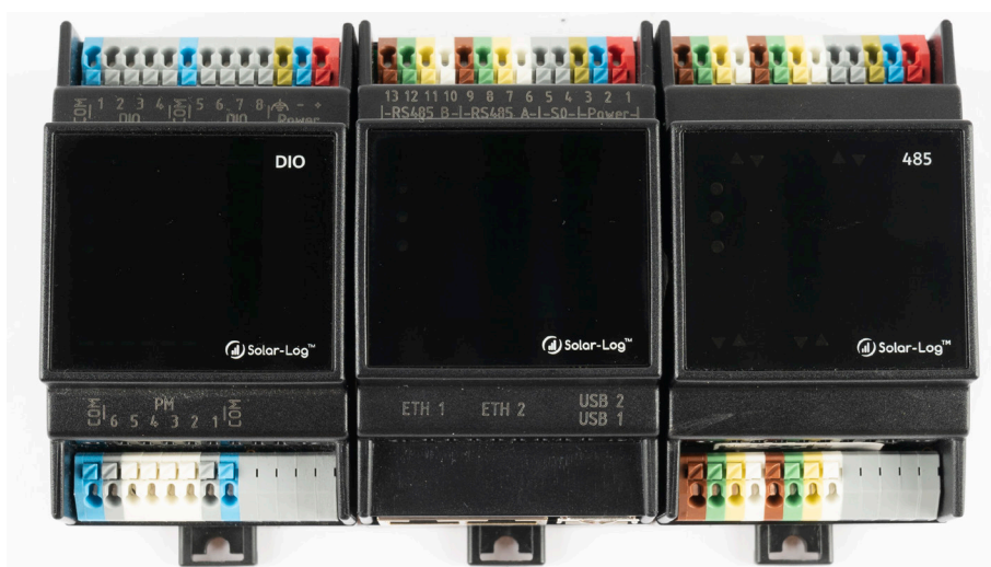
Fig.: Combinata Solar-Log Base con Solar-Log MOD I/O e Solar-Log MOD 485 (collegato - fronte)
